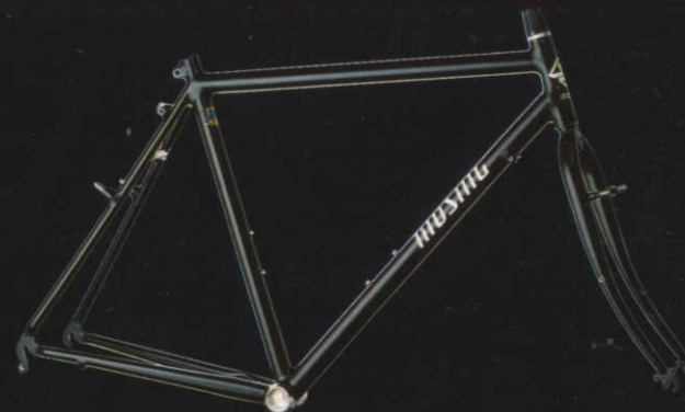
Fuera (Trekking-Frame) Rahmen: Aluminium-Legierung 7020 Gabel: Cro.-Mo. Unicrown Gewicht: Rahmen: 1600 gr., Gabel: 800 gr. Farbe: Matt Schwarz
