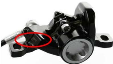
**Betroffen sind ausschließlich MT6- und MT8-Bremsen und auch nur solche mit den Produktionsnummern bis 20531, ebenso alle MT6- und MT8-Bremsen, auf denen sich keine Produktionsnummer befindet. Die Produktionsnummer finden Sie gelasert auf der Bremszange (siehe Foto).**
