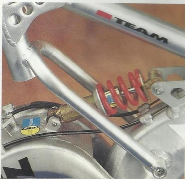
Die Motorrad-Technik ist nicht zu übersehen. Das komfortable Zentralfederbein ist ein Gasdruckstoßdämpfer von Bilstein, der speziell für das CENTURION MOUNTAIN CYCLE entwickelt wurde.
