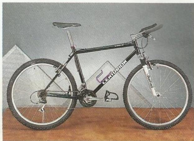
RACoon und RACoon SX mit CENTURION MT2 CrMo-Rahmen. Komplett ausgestattet mit Shimano Alivio, 7fach Rapidfire-Schalthebeln, Aheadset-Vorbau, ProCraft Bullhornlenker und ProCraft Flite Sattel. Alle Zugführungen liegen auf dem Oberrohr. Das RACoon ist auf den Einbau einer Federgabel vorbereitet, das RACoon SX mit einer SR Duo Track 7001 Federgabel ausgerüstet. Gewicht: RACoon 12,6 kg, RACoon SX 13,1 kg. Farben: teamgelb oder schwarz.
