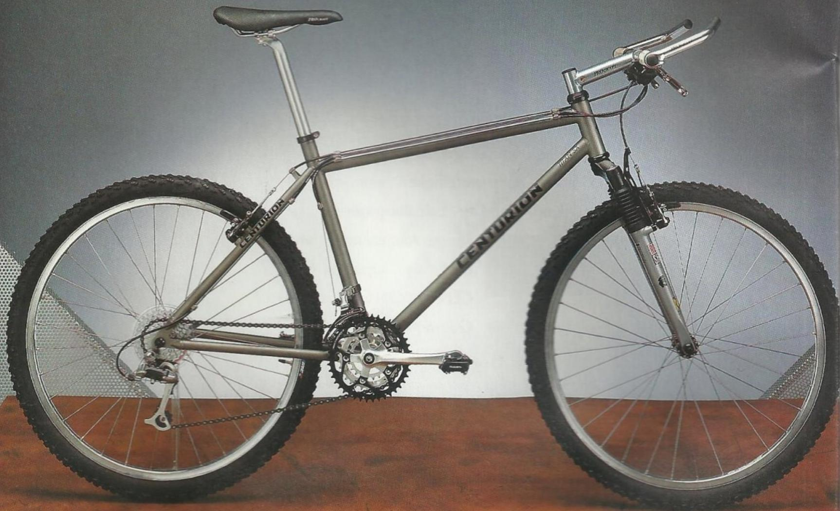
Die luft-, ölgefederte MAG 21 gehört in puncto Federung und Dämpfung zum Besten. Für ihre enorme Seitensteifigkeit sind die neuen »Brake Boosters« und die neuartigen Befestigungen verantwortlich. Hohe Verwindungssteifigkeit erzielt diese Federgabel durch den Einsatz der »Gullwing« Kronen. Ihre Magnesiumrohre führen zu einem optimalen Verhältnis von Gewicht und Festigkeit. Die Dämpfung kann über Justierrädchen auf dem Gabelholm bequem eingestellt werden. Alles Handarbeit aus den USA.
