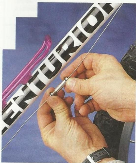
Durch einfaches Aufschrauben der Schaltzug-Kupplung am Unterrohr kann die Verbindung zu den Schalthebeln blitzschnell gelöst werden. So ist der Wechsel des Lenkers kein Problem.
