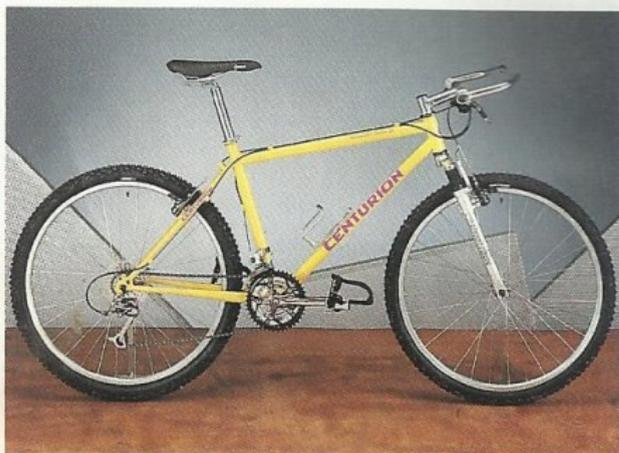
*RACCOON Team und RACCOON Team SX mit CENTURION MT2 CrMo-Rahmen. Komplett ausgestattet mit Shimano STX Special Edition, 7fach Rapidfire Plus Schalthebeln, ProCraft Lite Lenker mit Hyperends und ProCraft Flite Sattel. Alle Zugführungen liegen auf dem Oberrohr. Das RACCOON Team ist auf den Einbau einer Federgabel vorbereitet, das RACCOON SX mit einer SR Duo Track 8001 Federgabel ausgerüstet. Gewicht: RACCOON Team 12,4 kg, RACCOON Team SX 12,9 kg. Farben: teamgelb oder schwarz.*
