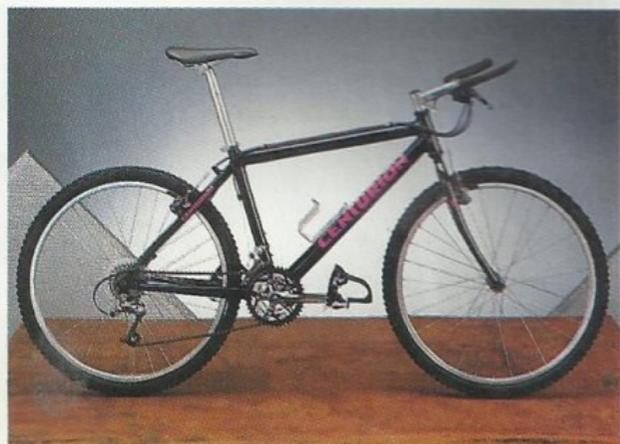
*BACKFIRE mit Rahmen aus kaltgezogenen, nahtlosen AL 7005 Aluminium-Rohrsätzen. Komplett ausgestattet mit Shimano STX Special Edition, 7fach Rapidfire Plus Schalthebeln, Aheadset-Vorbau, ProCraft Bullhornlenker und ProCraft Flite Lite Sattel. Alle Zugführungen liegen auf dem Oberrohr. Das BACKFIRE ist auf den Einbau einer Federgabel vorbereitet. Gewicht: 11,3 kg. Farben: teamgelb oder schwarz.*
