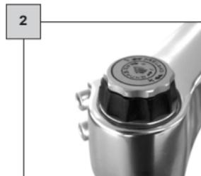
Der Einstellknopf der Druckstufendämpfung an der Quake CP befindet sich am unteren Ende des Tauchrohrs. Um die Dämpfung zu erhöhen, den Knopf in Uhrzeigersinn drehen, zum Verringern entgegengesetzt drehen (3).
