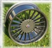
BBS Felgenstern beschichtet in silber + Klarpulver, Felgen- schüssel poliert
