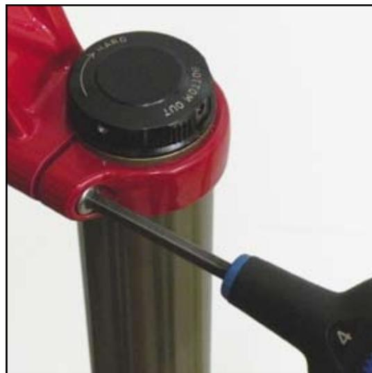
**2** Lösen Sie mit einem 1,5-mm-Inbusschlüssel die beiden Einstellschrauben, die den Durchschlagswiderstand-Einsteller an der Oberseite des Gabelbeins auf der Nicht-Antriebsseite fixieren (die Einstellschrauben müssen nicht entfernt werden). Entfernen Sie den Durchschlagswiderstand-Einsteller.
