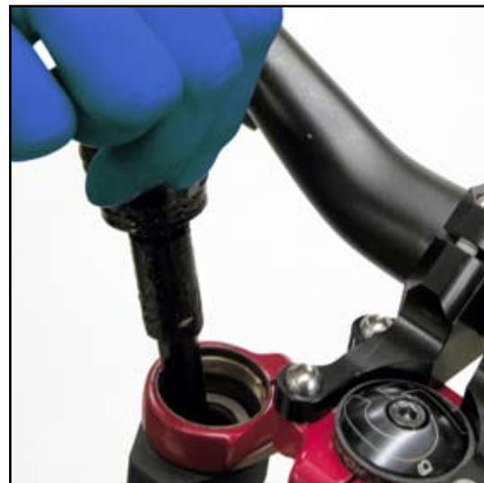
**10** Ziehen Sie die Abdeckkappe mit einem 24-mm-Steckschlüssel mit 7,3 N·m fest.
