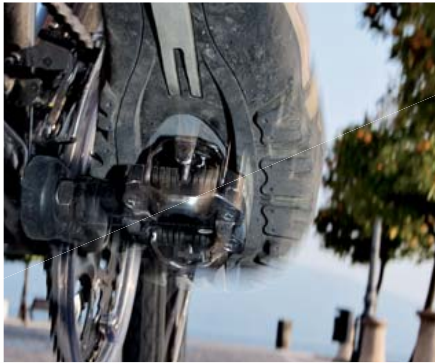
Die Schuhplatten von Klickpedalen müssen eine natürliche Rotation im Knie zulassen.
