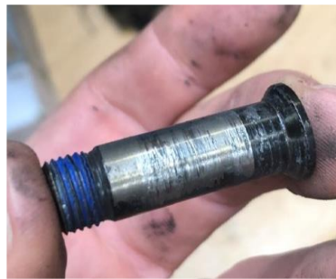
Bild 1: Beispiel eines beschädigten Dämpferschraubens
