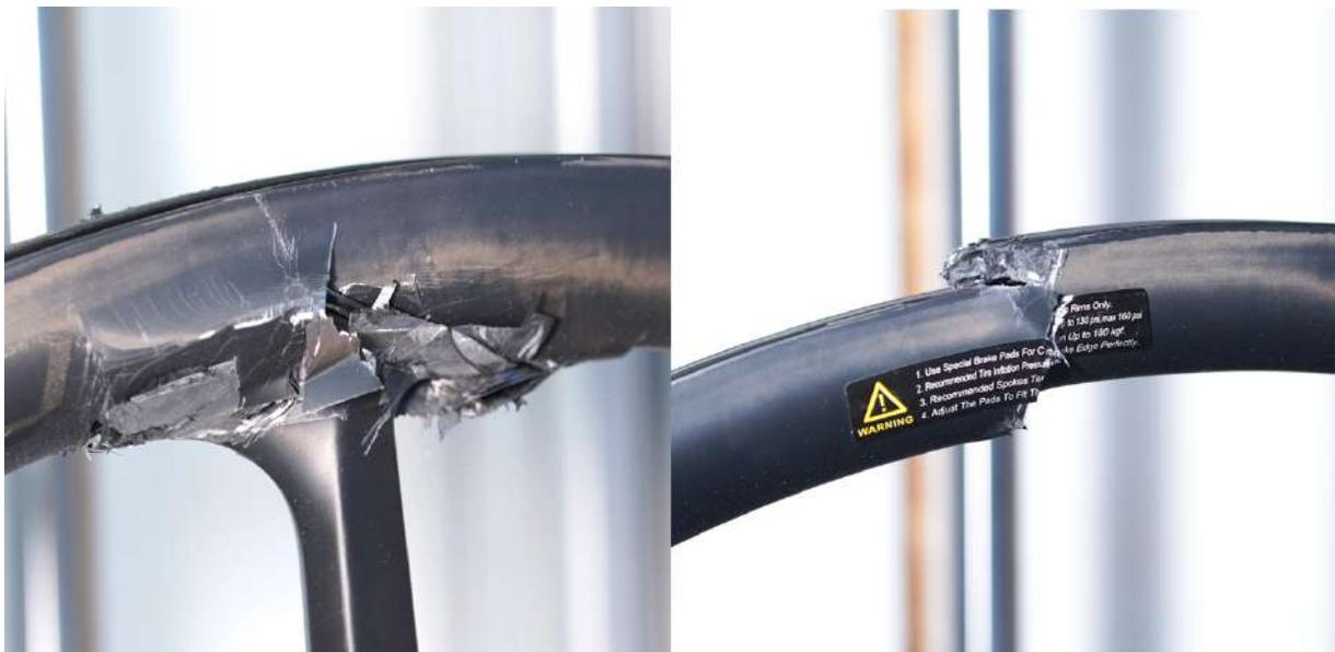
BITURBO Fakes nach dem Prüfstandtest: Die getesteten Exemplare versagten bereits bei der UCI-Mindestnorm DIN EN ISO 4210-7/2023 (40 Joul). Sie sind damit ein großes Sicherheitsrisiko. Originale BITURBO Laufräder zeigen bei diesem Test keinerlei Schäden.
